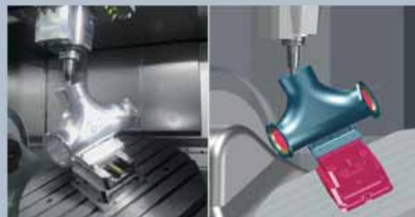
Tebis使用者所使用的工藝庫均以數字化形式呈現真實的生產環境。工藝庫包含機器、機器輔助設備、控件、刀具、夾治具的幾何、運動、技術訊息。在數字化的製造環境中，NC編程人員可以明確定義所選機器和刀具的設置，模擬刀具路徑，並在計算過程中避免碰撞。該功能確保製造過程中NC代碼的安全。
